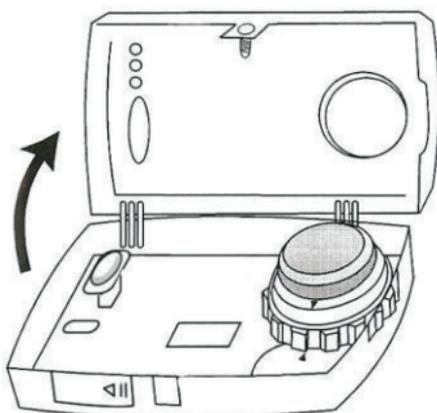
3. Два монтажных отверстия находятся на заднем корпусе. Обозначить их положение на стене, где будет установлен регулятор. Прodelать два отверстия по 6 мм, вложить распорочные дюбеля и прикрутить регулятор болтами.
